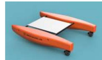
Prototipo del drone marino impiegato per il monitoraggio autonomo delle praterie di fanerogame sommerse.
