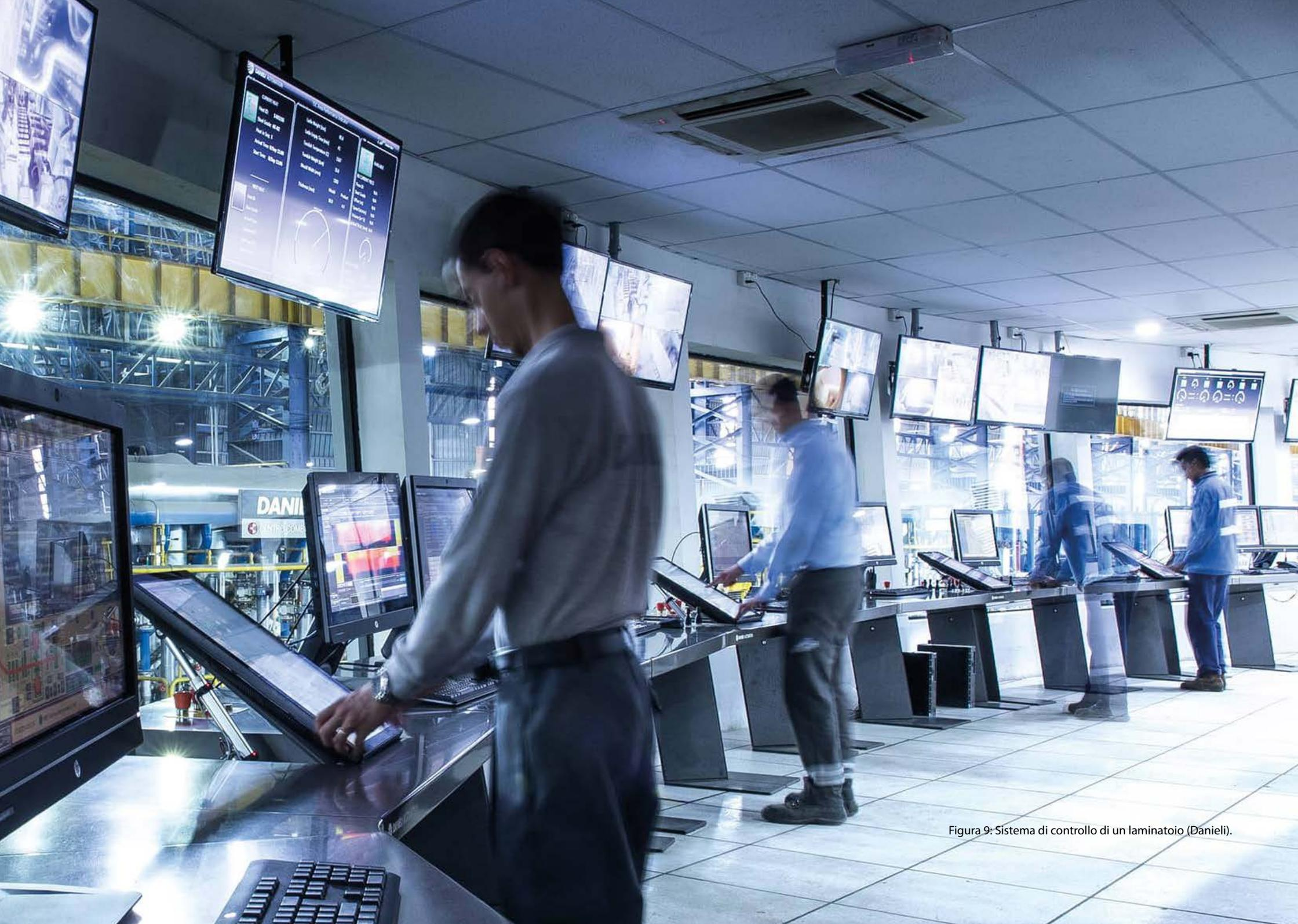
Figura 9: Sistema di controllo di un laminatoio (Danieli).
